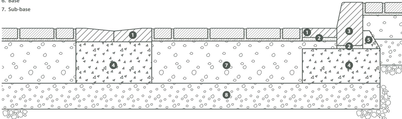
Existen dos métodos de ejecución, según se encofre esta cama de hormigón o no. Usando encofrados de madera, el coste no se encarece sensiblemente, si bien es necesario el empleo de más tiempo en la ejecución. El no recurrir a encofrados y extender el hormigón directamente puede significar una pérdida de hormigón si no se requiere este exceso en las capas de la calzada.
